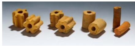
图 1 孟莫克®硫酸催化剂的几种形状（左至右为：GEAR/XLP（XCs/SCX）/LP（Cs）/T）
